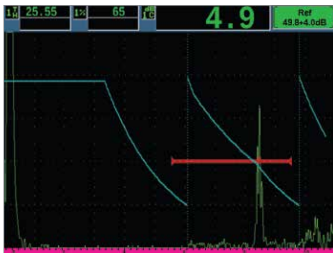
EPOCH 650探伤仪的动态DAC/TCG功能
