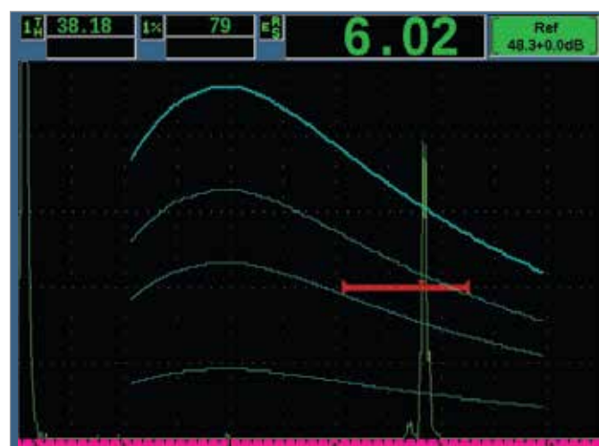
EPOCH 650探伤仪的DGS/AVG功能 - 全屏模式
